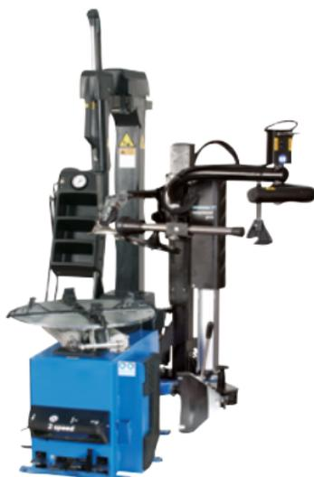
**Шиномонтажный станок для колёс диаметром до 26"**
