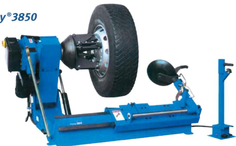
**Шиномонтажный станок для монтажа и демонтажа камерных и бескамерных шин ГА и АБ с монтажным ручьём и замковым кольцом**
